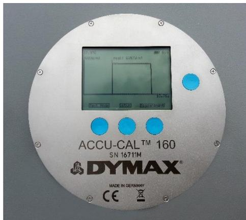
Figure 1. Puck-Style Radiometer
