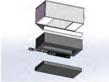
Abbildung 5. Bestandteile eines BlueWave QX4 V2.0 - LED Kopfs
