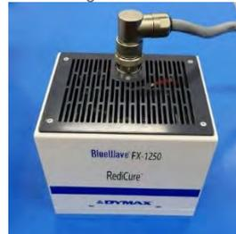
**Achtung:** Achten Sie beim Einstecken der Stecker in die Buchse auf die Passfeder und die Passfedernut jedes Steckers. Die Passfeder muss mit der Nut übereinstimmen (Abbildung 14).
