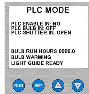
图 23：设置 PLC 开关的提示信息
