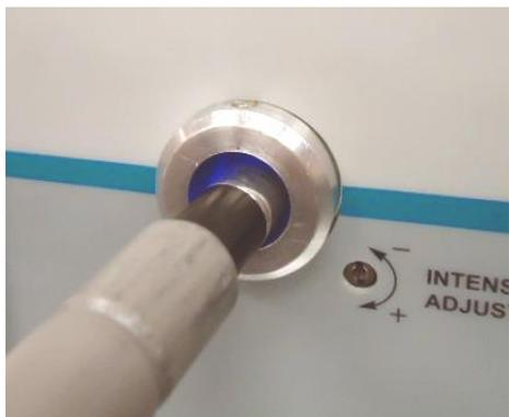
图 6：用六角扳手轻轻拧紧光导座上的固定螺丝
