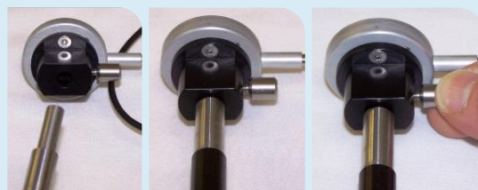
Figure 5. Fissare la testa del sensore al fotoconduttore (Passaggio 4)
