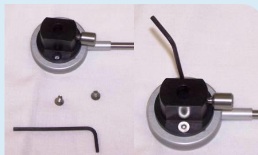
Figure 5. Fissare la testa del sensore al fotoconduttore (Passaggio 4)
