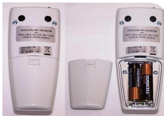
Fig. 7: Vano batterie (chiuso e aperto)
