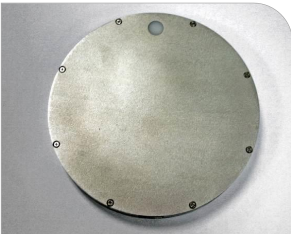
Abbildung 8. Aussparung für die Optik (auf der Rückseite des Radiometers)
