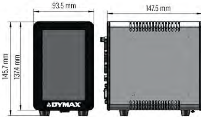
Abbildung 42. Abmessungen – Steuereinheit (PN: 88806)
