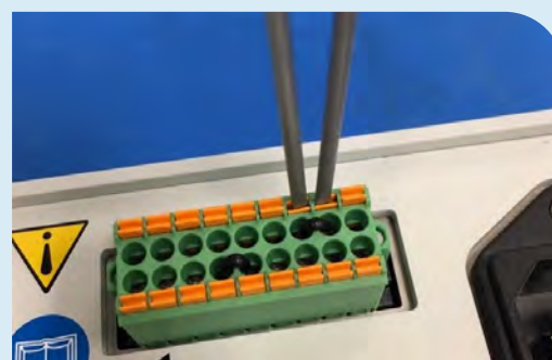
Abbildung 11. Brücke von der Klemmenleiste abnehmen.
