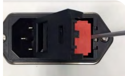
Abbildung 50. Heben Sie die Sicherungshalterung an
