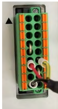
Abbildung 17. Pin-Positionen für Fußschalterverdrahtung
