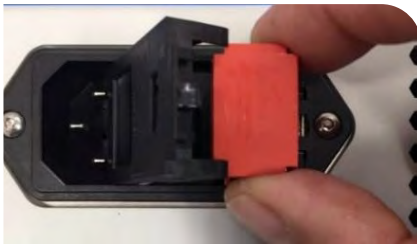
Abbildung 51. Entfernen Sie die Sicherungshalterung
