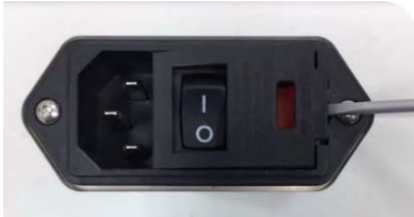
Abbildung 49. Öffnen Sie die Sicherungsabdeckung
